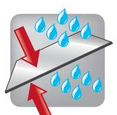
Тканые геотекстили компании Thrace находятся в равновесии с грунтом, что позволяет протекать **достаточным потокам жидкости при минимальных потерях грунта** через плоскость геотекстиля и без забивания пор.
